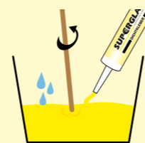
Primer: Gemisch aus Dichtkleber und Wasser
